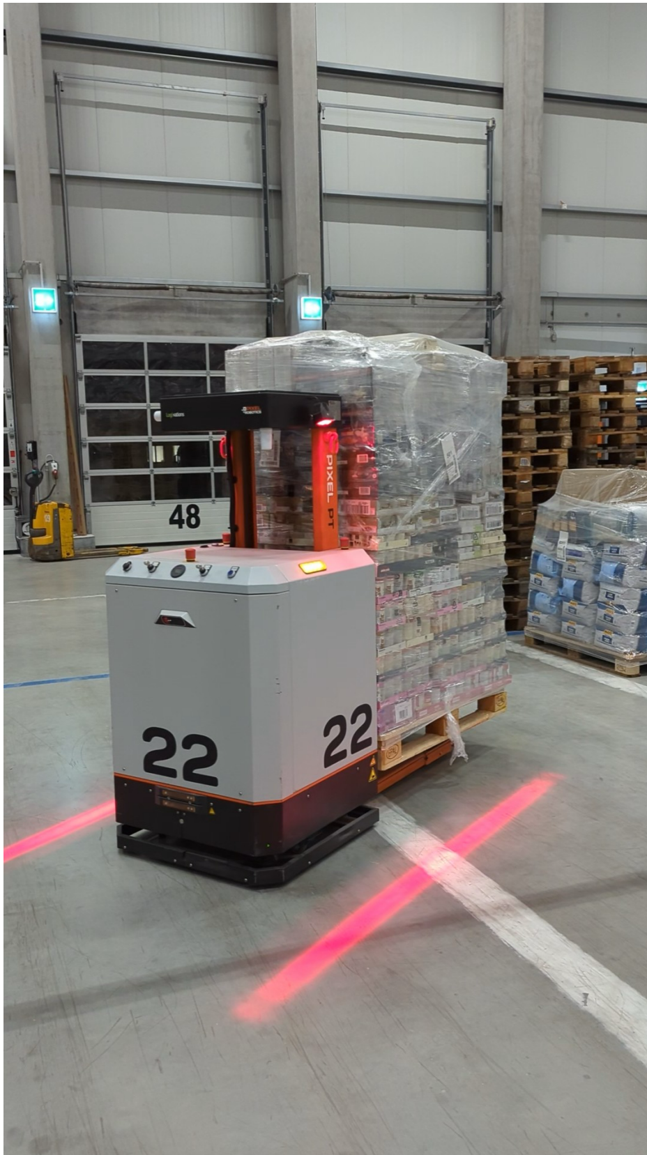
Bild 1: KI-Transportroboter: Fahren mit Folie im Sichtfeld des Sicherheitsscanners (Quelle Pixel Robotics)
